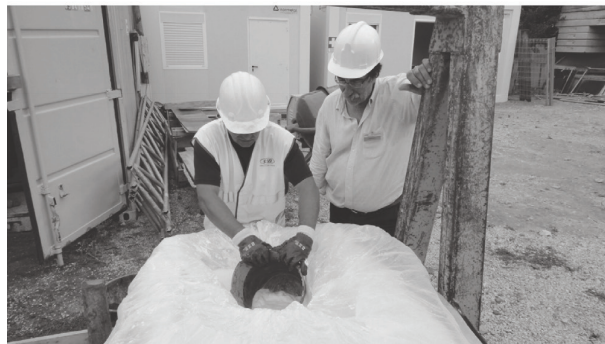
Ensaio de produção de argamassa à base de cal aérea em pasta. Claustro dos Corvos. Convento de Cristo.
